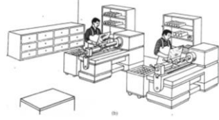
Şekil 5. Atölyede Yapılan Temizlik, Tertip Ve Gereksiz Malzemelerin Dolaplara Kaldırılmasından Sonra, Daha Huzurlu Ve Güvenli Bir Çalışma Ortamı Oluşur.
